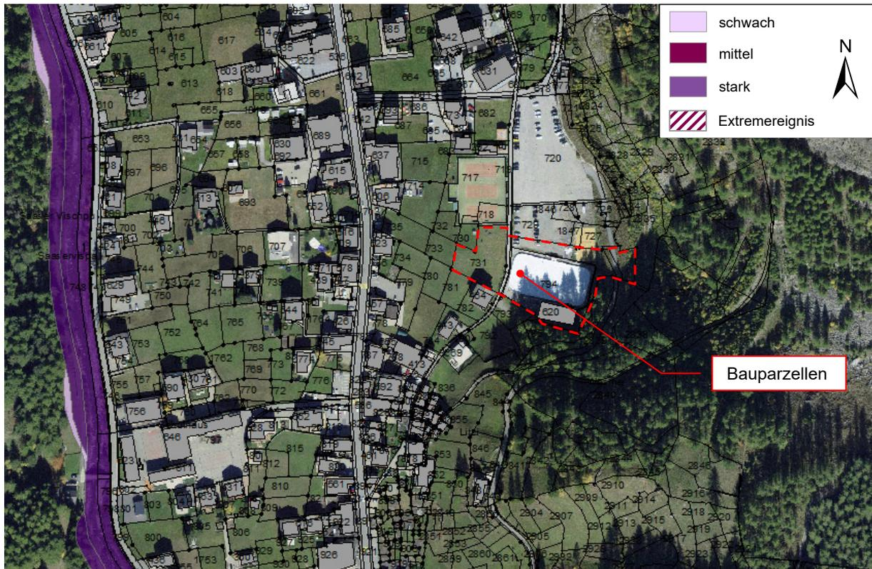
Abbildung 18: Ausschnitt Intensitätskarte Hochwasser Saaservispa HQ<sub>30</sub> [4] mit Lage der Bauparzellen.
