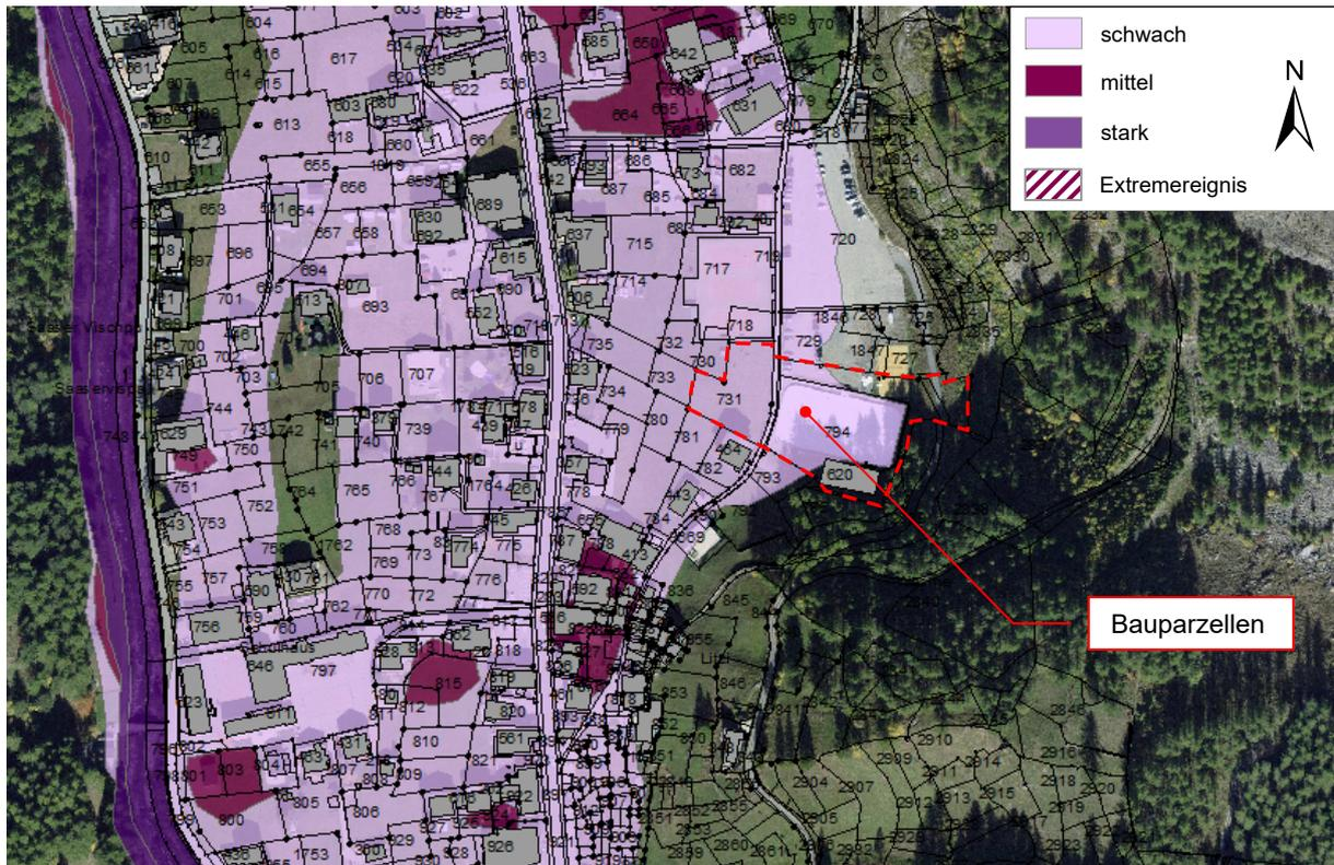
Abbildung 20: Ausschnitt Intensitätskarte Hochwasser Saaservispa HQ<sub>300</sub> [4] mit Lage der Bauparzellen.
